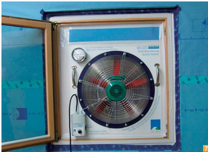
低価格・コンパクトな減圧装置。発煙筒と合わせて使うことで漏気箇所を探知できる
